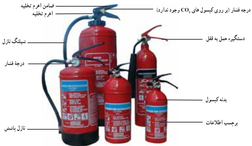
شکل ۲-۲- اجزای کیسول های اطفای حریق
